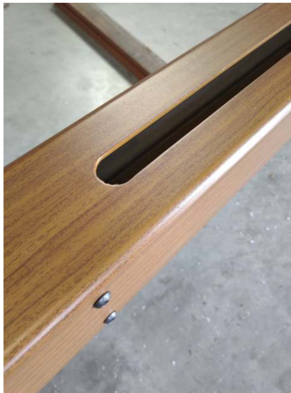
Principe de gorge usinée dans le profilé en acier destinée à la fixation des flèches et panneaux.
